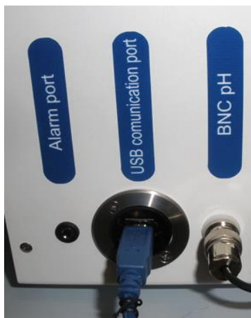
Joonis 20.1 BNC-pistikuga ühendatud pH-sond
