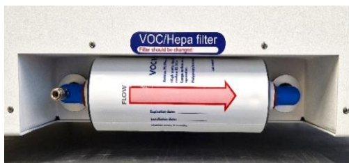
Joonis 12.3 Õigesti paigaldatud VOC/HEPA filter
