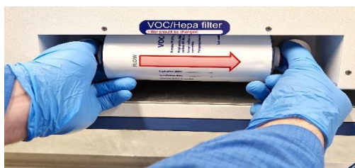
Joonis 12.2 VOC/HEPA-filtri paigaldamise ja eemaldamise protseduur.
