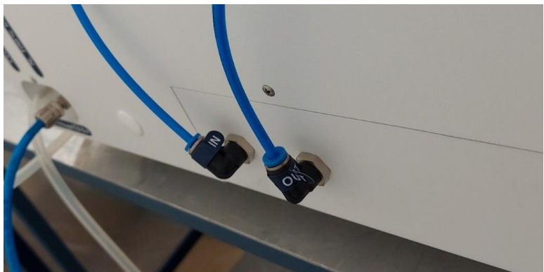
Joonis 23.1 Toru ühendus niisutuspuudelil ja MIRI® Humidity multiruum IVF inkubaatoril.
