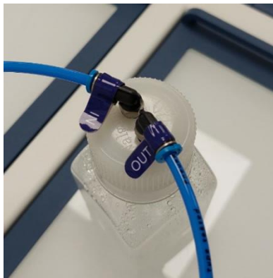
Joonis 23.1 Toru ühendus niisutuspuudelil ja MIRI® Humidity multiruum IVF inkubaatoril.
