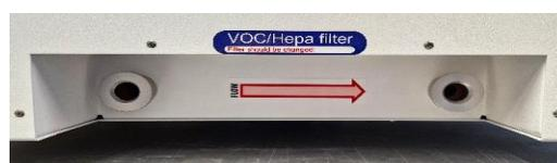
**Figura 12.1** Flecha de flujo de la incubadora multicámara FIV MIRI® II-12
