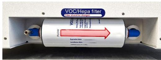
**Figura 12.3** Filtro COV/HEPA correctamente instalado
