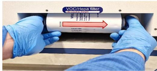
**Abbildung 12.2** Verfahren zum Einsetzen und Entfernen des LCKW/HEPA-Filters
