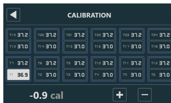
Abbildung 13.19 Kalibrierung der Temperaturansicht der Zone T1
