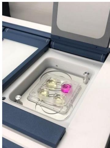
**Abbildung 18.3** 4er-Mehrfach-Schale mit 3 Puffern und Medium
