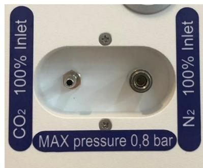
**Figure 11.1** Entrées de gaz à l'arrière de l'incubateur pour FIV à compartiments MIRI® II-12
