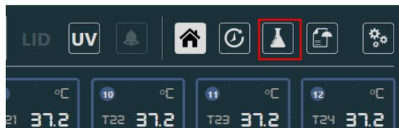
**Figure 13.14** Emplacement de la touche de mesure du pH sur l'écran principal
