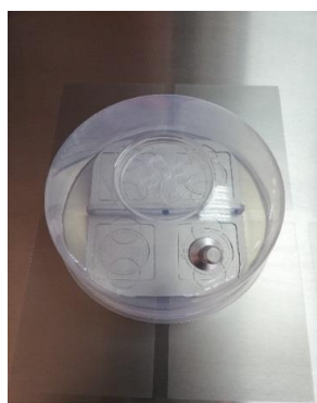
Figura 11.8 Exaustor de gás colocado sobre o pulverizador de gás
