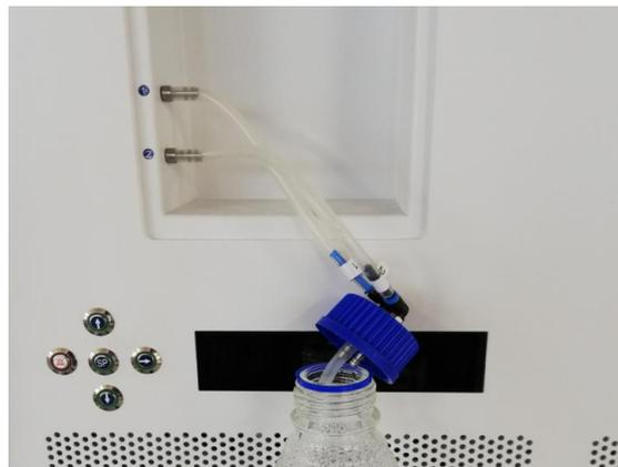
**Abbildung 11.4** Befeuchtungskolben
