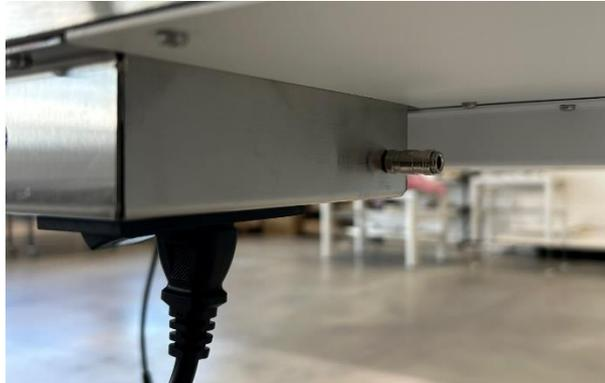
Abbildung 11.1 Gaseinlass unter Single-Tischplatte
