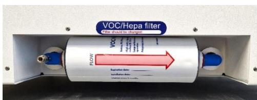
**Figura 12.3** Filtro VOC/HEPA installato correttamente
