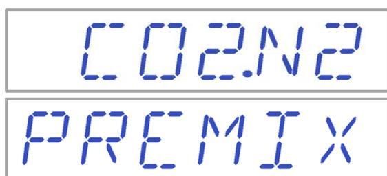
**👉 Lors de l'utilisation du mode gaz prémélangé, il est obligatoire d'utiliser un gaz prémélangé avec une gradation plus ELEVEE que la valeur de consigne. Par exemple, pour atteindre 5 % de CO<sub>2</sub> dans le point de consigne du gaz, le gaz prémélangé doit contenir AU MOINS 6 % de CO<sub>2</sub> dans son mélange.**
