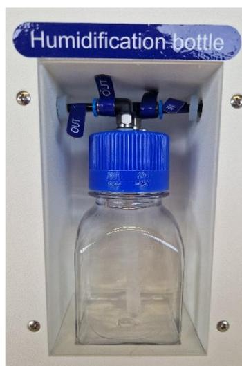
**Figure 22.1** Raccordement du tube sur la bouteille d'humidification et l'incubateur Mini MIRI® Humidity multiroom FIV
