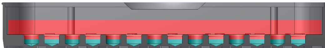
Abbildung 10.3 Die Kulturgefäße werden mit einer Mineralölschicht bedeckt und der Deckel wird aufgesetzt
