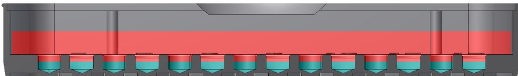
Figura 10.3 Los pocillos de cultivo se cubren con una capa de aceite mineral y las tapas se ponen encima
