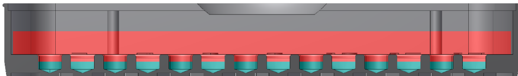
Εικόνα 10.3 Τα φρεάτια καλλιέργειας είναι καλυμμένα με ένα στρώμα ορυκτελαίου και το καπάκι είναι τοποθετημένο
